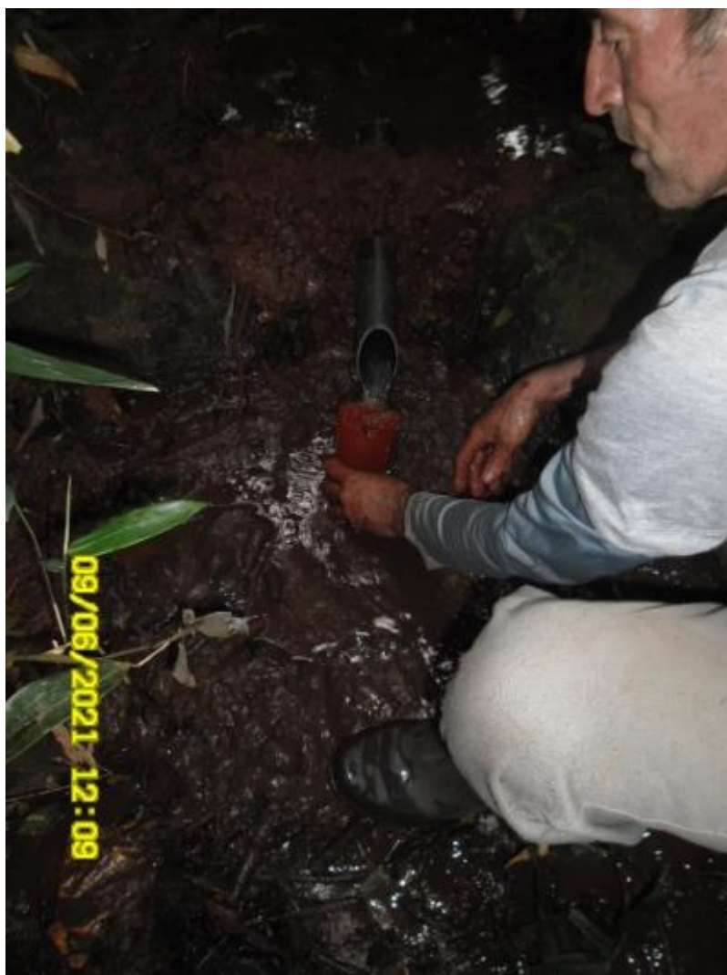
FOTO 43 – Vista da medição volumétrica do ponto VS-06-NA08.
