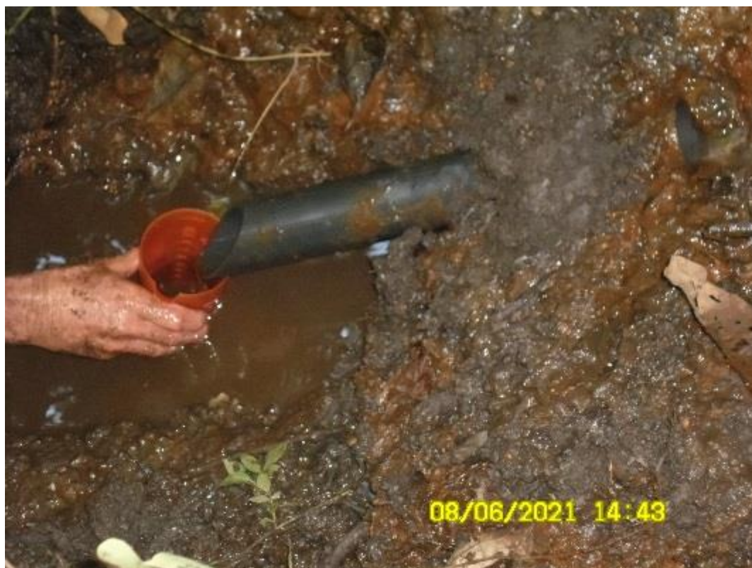
FOTO 47 – Vista da medição volumétrica do ponto VS-07-NA09.
