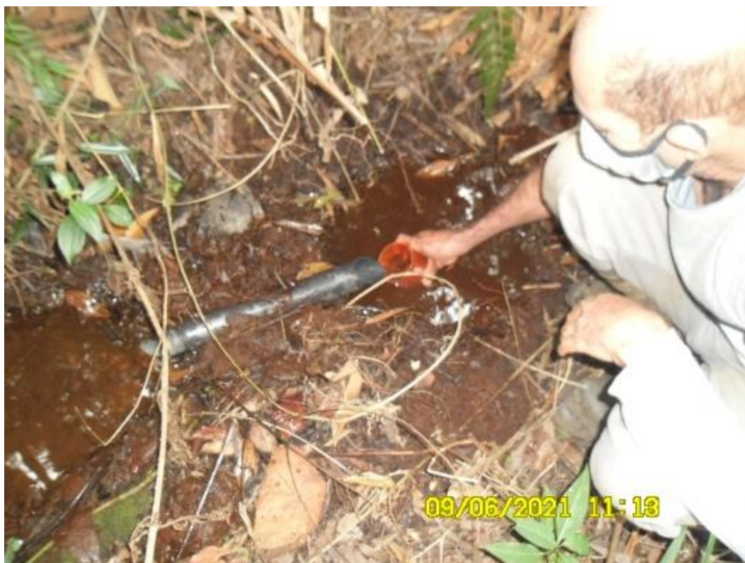
FOTO 53 – Vista da medição volumétrica do ponto VS-09-NA22.
