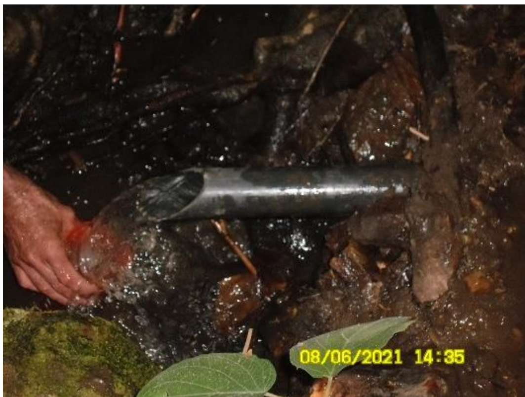
FOTO 50 – Vista da medição volumétrica do ponto VS-08.
